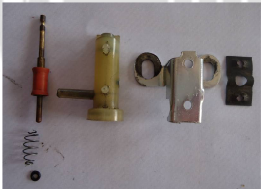
zerlegtes Vakuumventil mit Innereien
